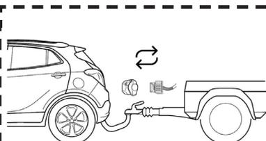
Der Funktionstest kann nur einmal je Steckverbindung durchgeführt werden. Für einen erneuten Testdurchlauf den Stecker abziehen und wieder einstecken.
