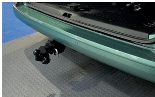
Receiver Hitch mit Kugelplatte und Sicherungsstift
