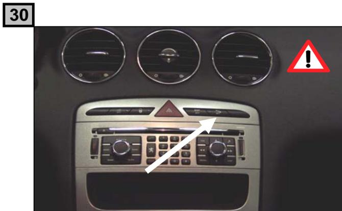
Lors du branchement de la remorque ,désactiver le système "RADAR DE RECU" au tableau de bord
