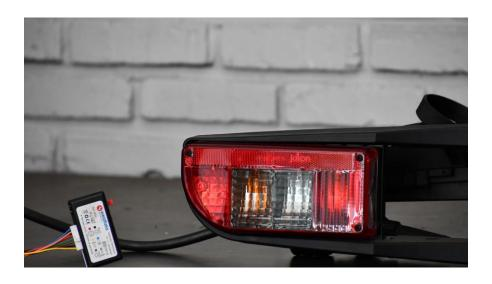
C. Pour chercher un numéro de configuration plus élevé, le shunt rouge doit être toujours inséré, il faut impérativement déconnecter le 12 volts du module pendant quelques secondes et après remise sous tension, le module passe à la configuration suivante.
