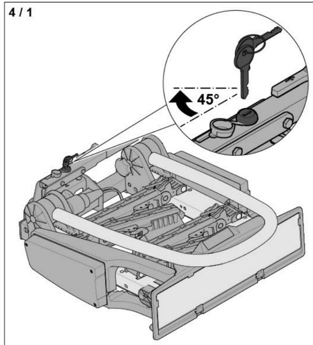
► Aprire la serratura della leva di tensionamento.
