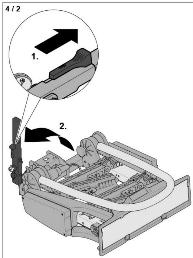
► Sbloccare la leva di tensionamento (1).
