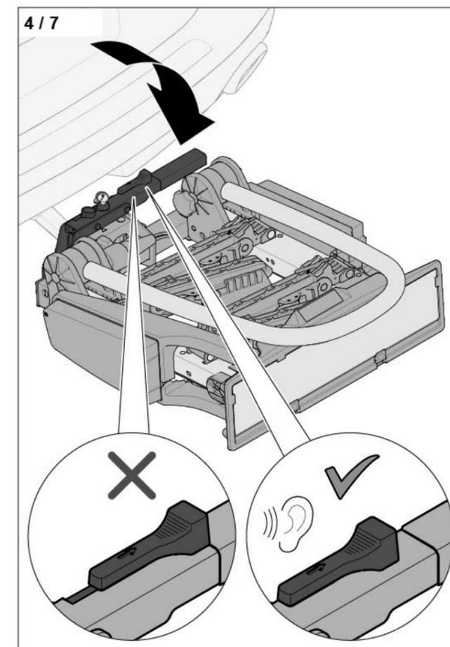
► Spingere la leva di tensionamento con una forza corrispondente ad un peso di 35 - 45 kg verso il basso fino al blocco in posizione.
