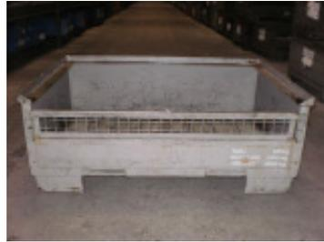
Abmessung: 1200x800x400 mm
