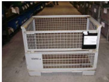
Innenabmessung: 1200x800x780 mm
